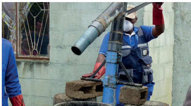
Figure 4.8 : Tarière à boues motorisée en Afrique du Sud (photo : David M. Robbins).
