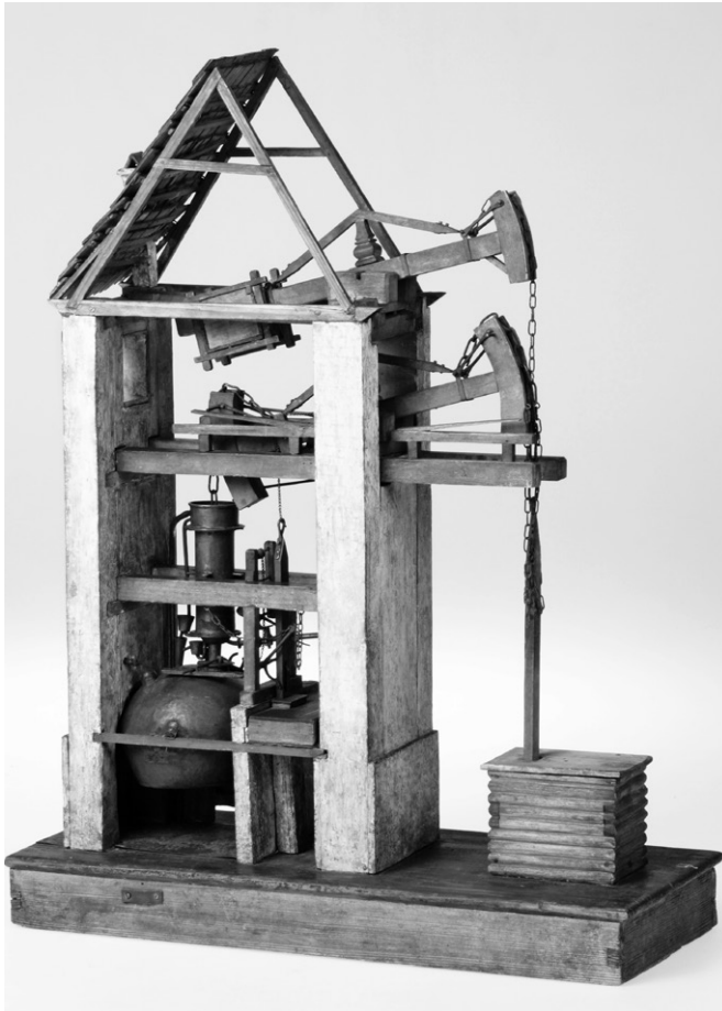
Abbildung 8: Modell einer Dampfmaschine Newcomenschen Typs, Schemnitz 1764 (?).
