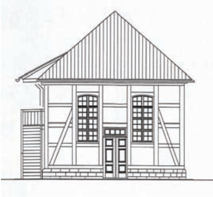
(Abb. 24: Bodenfelder Synagoge, Rekonstruktion Eingang auf der Südseite mit Aufgang zur Frauenempore)
