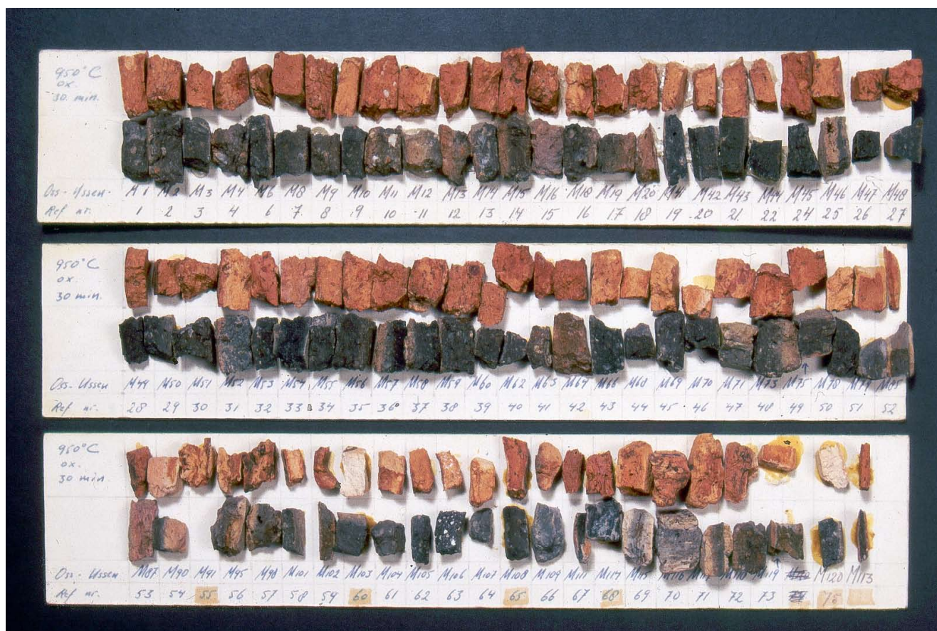
Figuur 9.1. Overgebakken aardewerkfragmenten (bovenste rijen) en scherven van dezelfde potten in originele toestand (onderste rijen).
