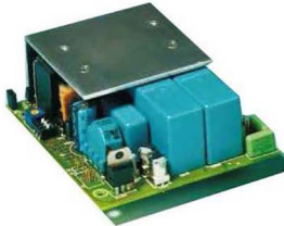
(a) RFID reader module
