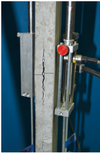
(a) Spaltrissbildung unter Zugbeanspruchung
