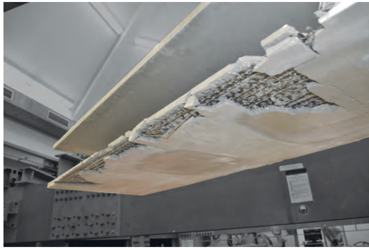
(b) Spaltrissbildung während eines Biegeversuches
