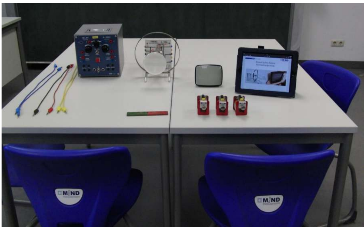
Abbildung 3: Experimentierstation „Braun'sche Röhre“ zum Thema Elektrizitätslehre.
