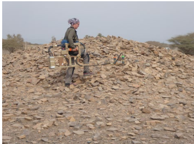
Abb. 36: Prospektion eines Umm an-Nar-zeitlichen Grabes in Bereich B-Süd mit dem Scintrex Smartmag SM4-G special (Foto: J. W. E. Faßbinder).
