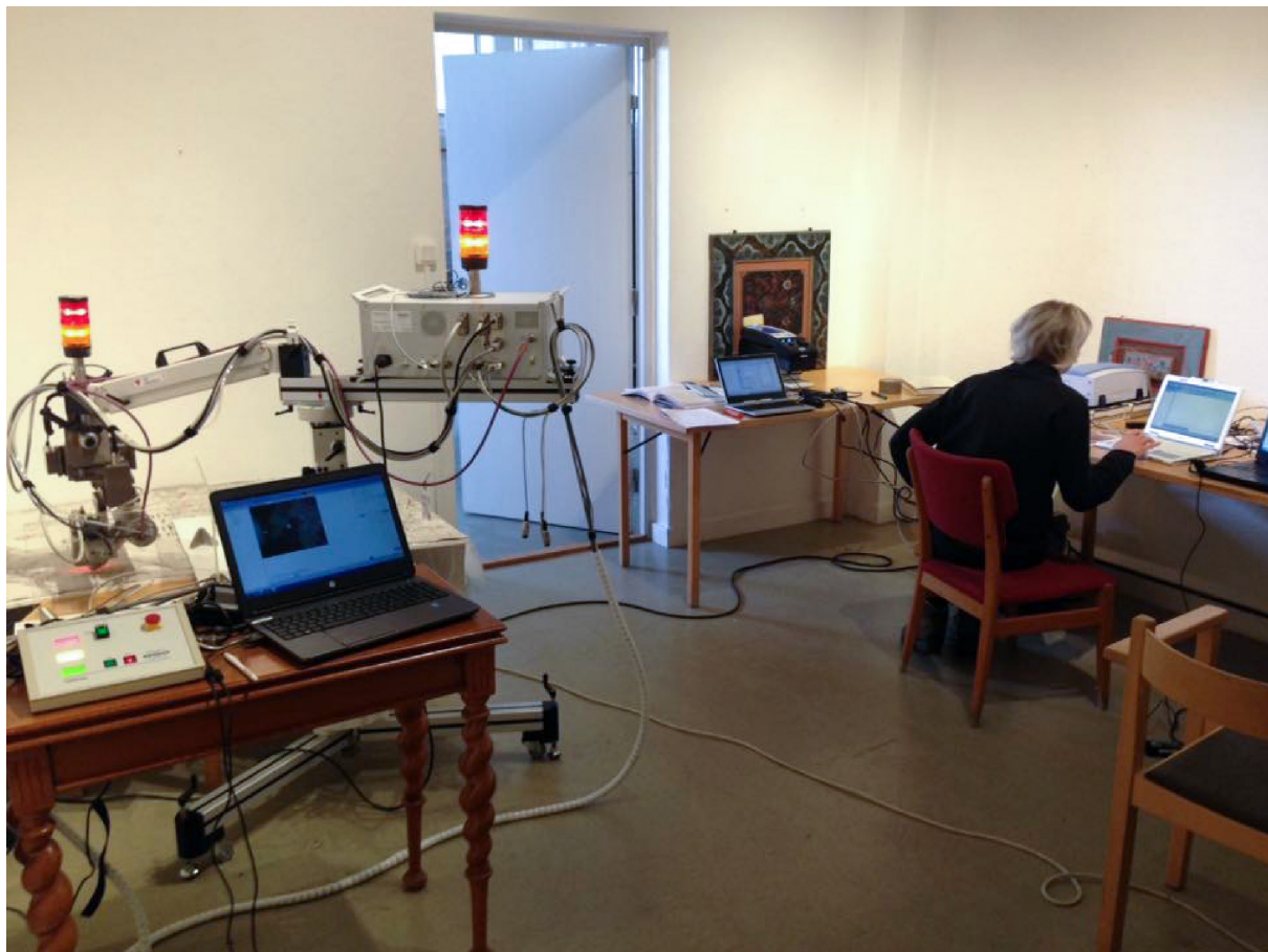
Figur 9 (3.1.9): Att utföra analyser ute i fält kräver tillgång till el. Här utförs XRF-analyser, Ramana-analyser samt FTIR-analyser. Ljusdalsbygdens museum. Foto: Anders Assis
