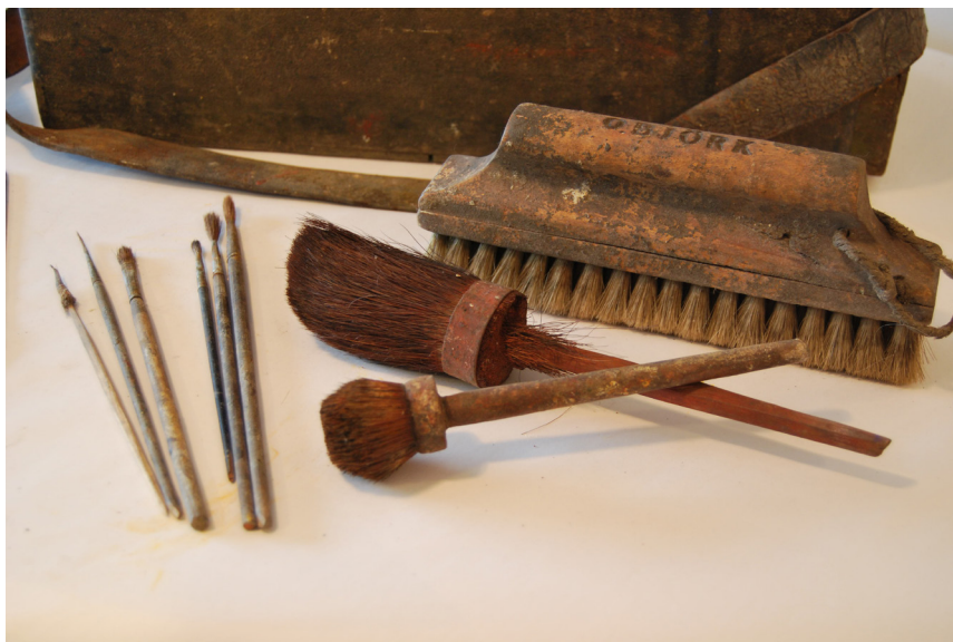
Figur 1 (3.4.1): Olika typer av penslar. Till vänster två fina, runda, spetsiga penslar som används för konturer. Tredje penseln från vänster är en platt svinborstspensel. Den runda, långborstade, tjocka penseln överst i mitten är en anstrykare medan den undre är en sorts stöpplare. Penslar från Göras Göran Hanssons samling, Bollnäs kulturhus. Foto: Liv Friis
