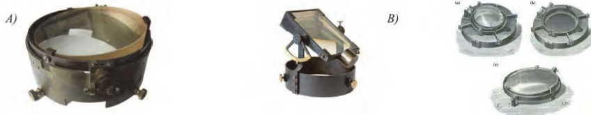
Fig. 4. A) Objective prism, Merz, Munchen, 1864, glass, brass, diameter 162 mm, angle of refraction 12 degrees. INAF museum - Osservatorio Astronomico di Roma; B) TRA CIELO E TERRA L'avventura scientifica di Angelo Secchi a cura di Ileana Chinnici e Mauro Gargano Comitato Nazionale per il Bicentenario della Nascita di Angelo Secchi © 2018 All Rights Reserved.
