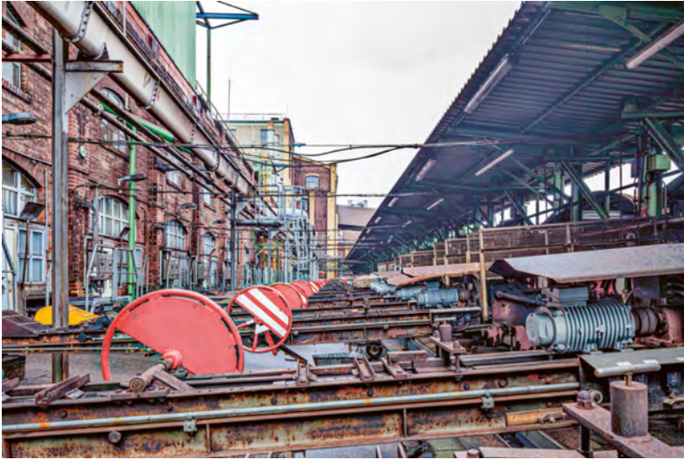
Abb. 7: Brikettfabrik Frechen-Wachtberg: Der Übergang der Rinnen aus der Gebäudefassade des Pressenhauses (links) ins Rinnenfeld, Foto 2022.
