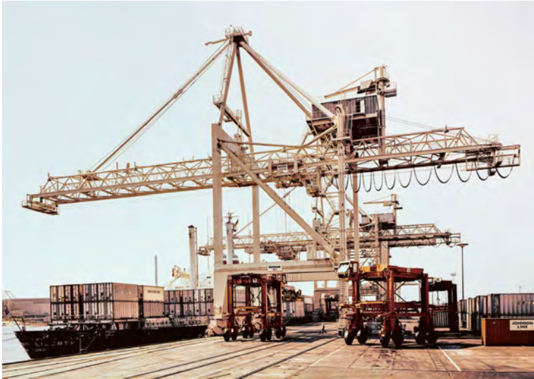
Abb. 4: Burchardkai, Hamburg-Waltershof, Containerbrücke mit Van Carriern, Foto 1970.
