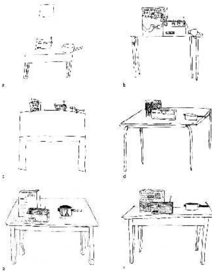
Abb. 36: Typische Zeichnungen zu den von Willats ermittelten Projektionssystemen: a) ein Projektionssystem, b) senkrechte Projektion, c) vertikal schiefe Projektion, d) schiefe Projektion, e) naive Perspektive, f) Perspektive.
