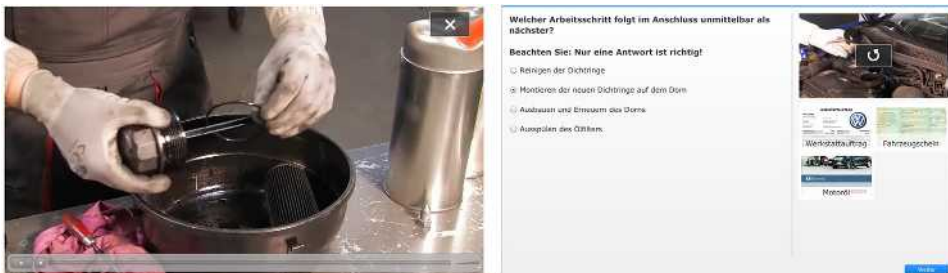
Abbildung 2: Screenshots aus dem computerbasierten Test zur Erfassung des Standardservice-Handlungswissens. Links: Standbild einer Handlungssequenz zum Ölwechsel; rechts: administrierte Fragestellung
