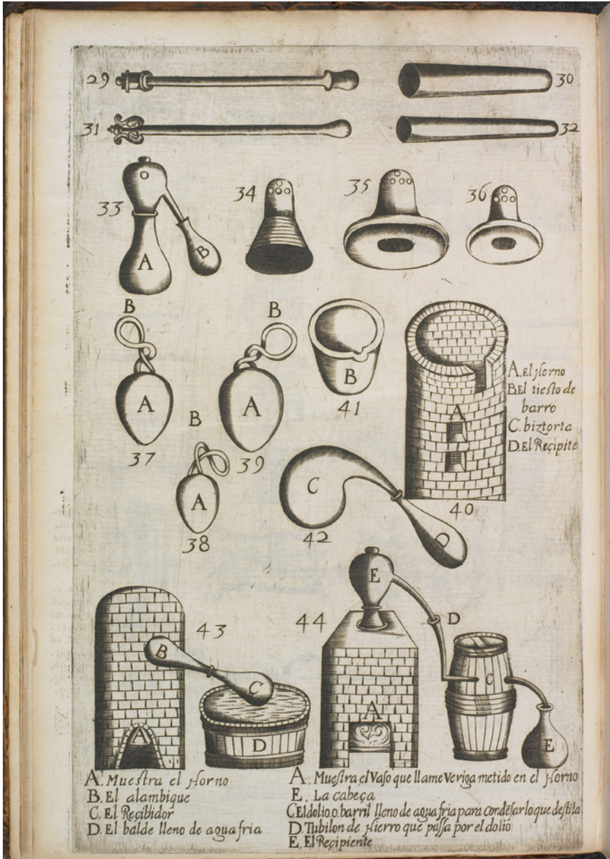
FIGURE 9 Distillation equipment depicted by Licenciado Pedro López de León, 1628. Source: Licenciado Pedro López de León, Práctica [sic] y teórica de las apostemas en general y particular: cuestiones y prácticas de cirugía, de heridas, llagas, y otras cosas nuevas, y particulares. Seville: Oficina de Luys Estupiñan, 1628. COURTESY BRITISH LIBRARY.
