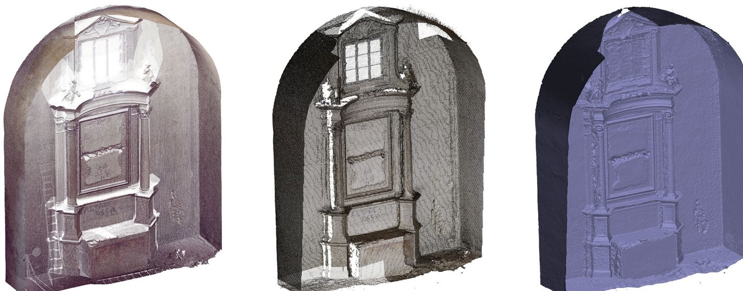
Fig. 15/ Cappella con altare estradossato, estrazioni da modelli numerici: a sinistra, points cloud da laser scanner; al centro, nuvola densa da fotogrammetria; a destra, mesh costruita automaticamente sulla base della nuvola densa. La qualità del dato metrico da TLS è nettamente superiore a quello fotogrammetrico, come si può vedere dal livello di definizione della mesh .
