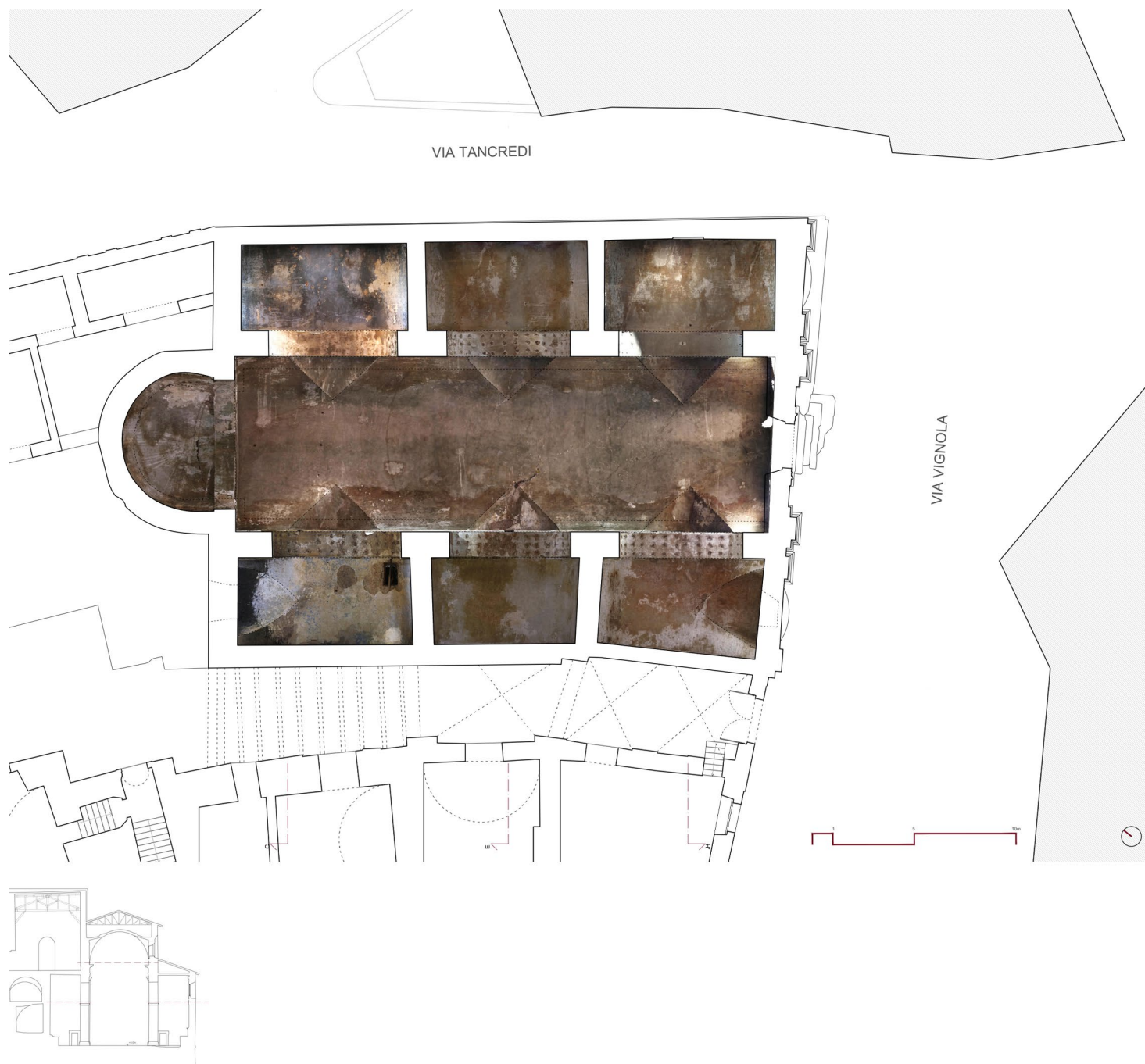
Fig. 46/ Pianta ipografica con ortofoto della volte.
